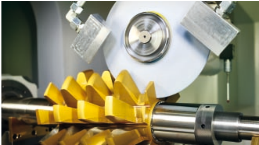
Die Multigrind CB ist der Größe der Schleifaufgabe gewachsen: Die Fräswerkzeuge haben ein Gewicht bis zu 600 kg, einen Durchmesser von maximal 500 mm und eine Länge von 600 mm.
