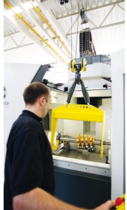
Bis zu acht Tage dauert die Fräsbearbeitung zur Herstellung der Zahnräder. Die Fräswerkzeuge der Wälzfräsmaschinen unterliegen dabei einem großen Verschleiß.
