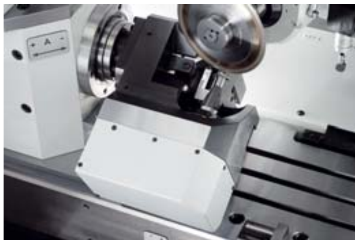
Die Zusatzeinrichtung einer sechsten Achse, die in der A-Achse gespannt wird, erlaubt es, das Werkstück um \pm 45^\circ zu verschwenken
