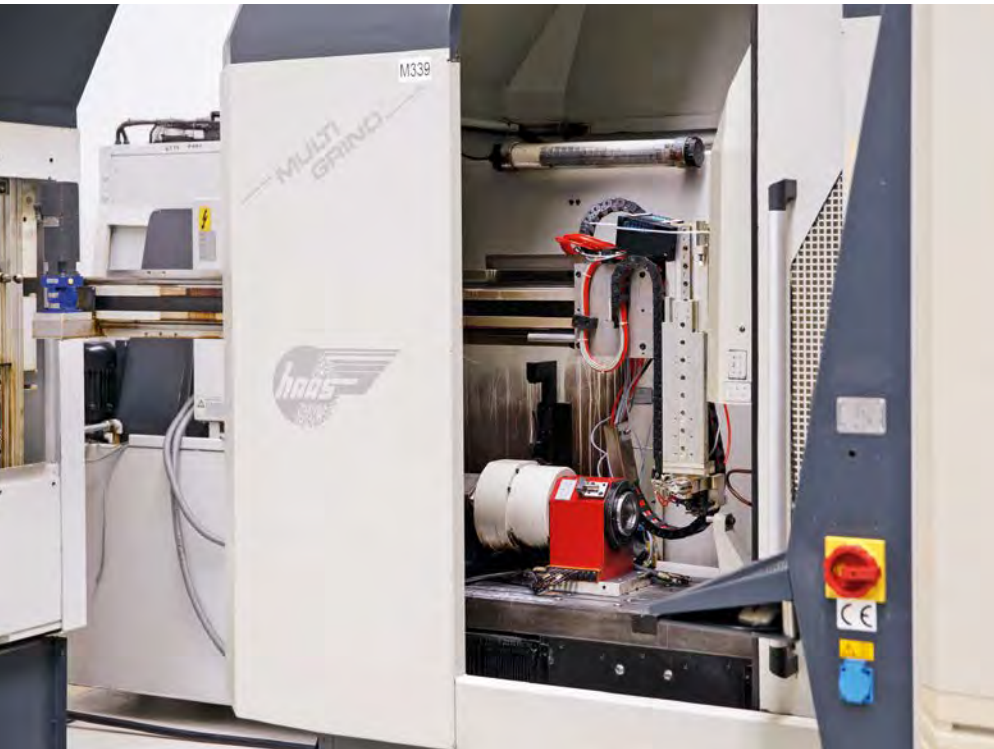
Eine Multigrind® HT, von 1998 bis 2010 gebaut, wird einem Retrofit unterzogen.
