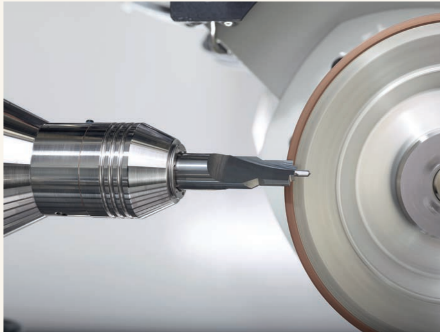
Bild 4: Präzise auch bei rotationssymmetrischen Werkzeugen: Multigrind® CU
