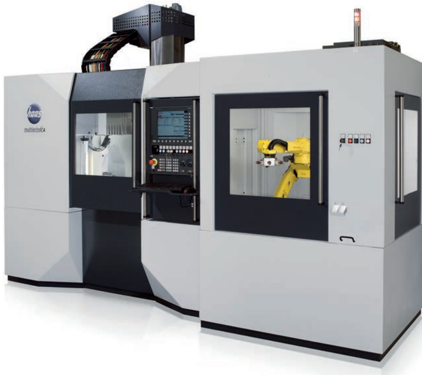
Bild 2: Im Zuge eines Retrofit-Projektes kann eine Schleifmaschine auch um eine Automationseinheit mit Roboterzelle erweitert werden
