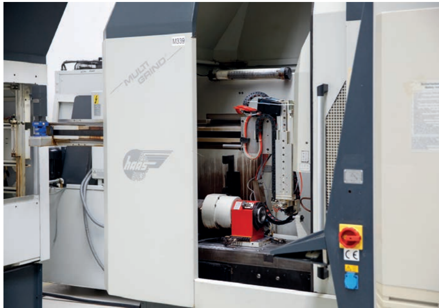
Bild 1: Eine Multigrind® HT, von 1998 bis 2010 gebaut, wird einem Retrofit unterzogen
